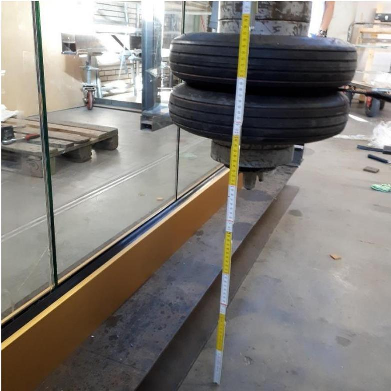
**Abbildung V 01-3: Ausmessen der Pendelhöhe**
