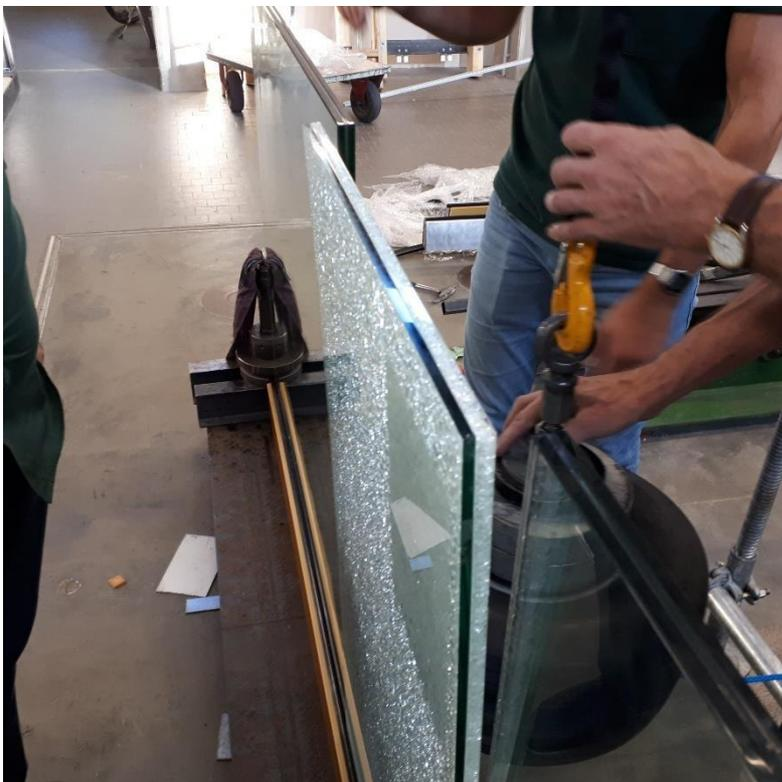
**Abbildung V 04-8: Verschiebung der Scheibe um ca. 3,5 cm**
