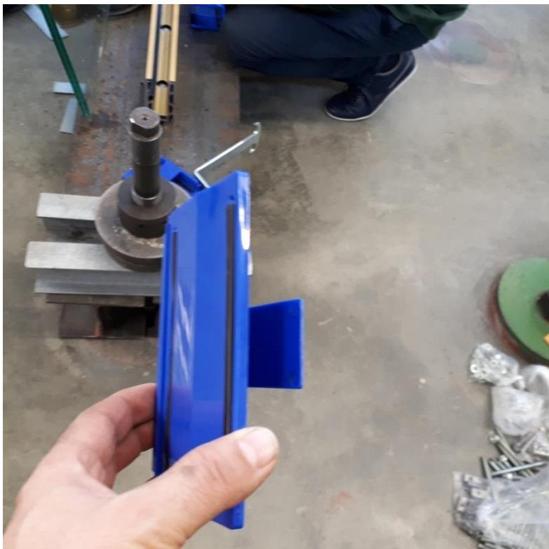
**Abbildung V 00-3: Rutschhemmend durch beidseitige Gummistreifen**
