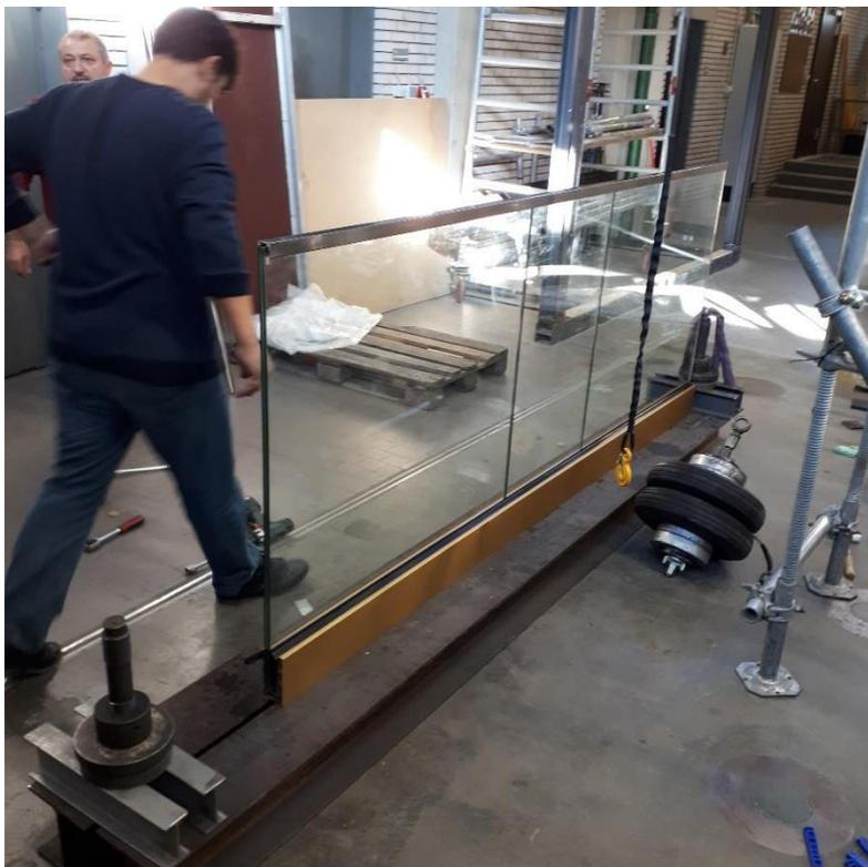
**Abbildung V 00-5: Abgeschlossener Versuchsaufbau inkl. Dichtung und Handlauf**
