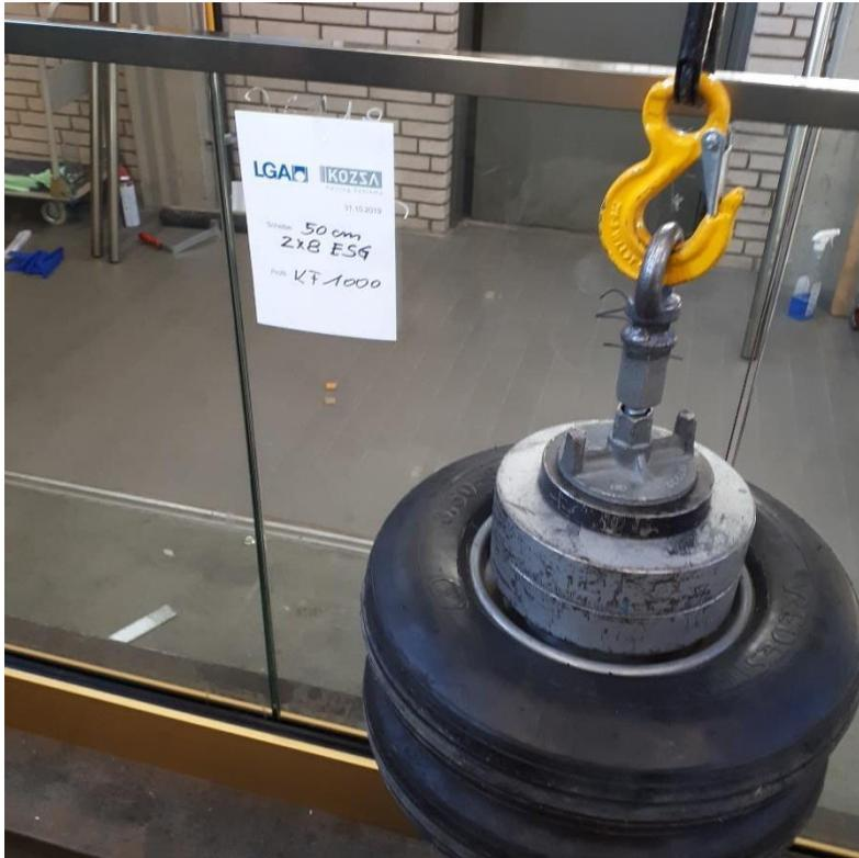
Abbildung V 01-1: Ausrichten der Versuchsvorrichtung auf den unteren Punkt 1.
