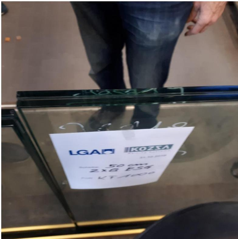
Abbildung V 03-3: Ca. 2cm Verschiebung am Handlauf
